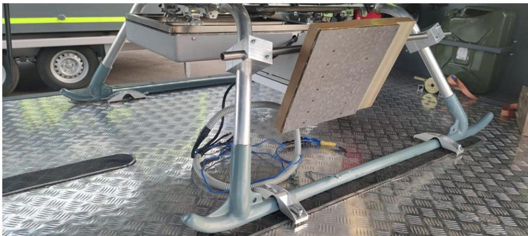
**Рис. 7.** Контейнер с оборудованием и антенна РЛС С-диапазона.
