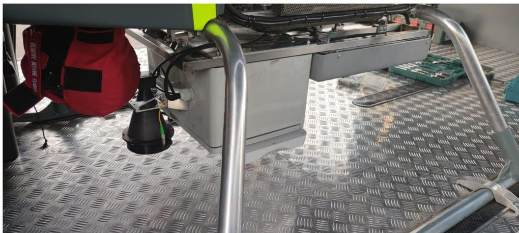
**Рис. 9.** Контейнер с оборудованием и модуль газоанализатора.
