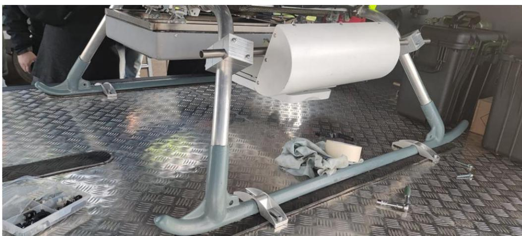
**Рис. 8.** Контейнер с оборудованием и антенна РЛС X-диапазона.
