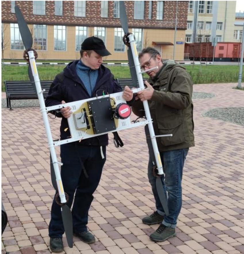
**Рис. 5.** Модуль газового анализа на БПЛА «Ирбис-424».
